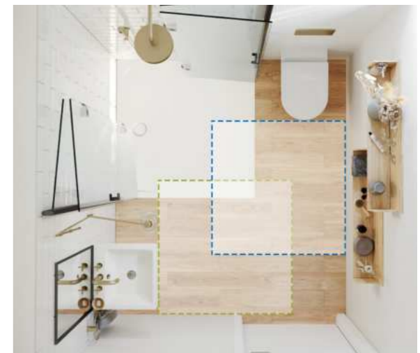
Barrierefrei auf kleinstem Raum: Mit der Cayonoplan Multispace von Kaldewei können die geforderten Bewegungsflächen im DIN-konformen Bad schon bei vier Quadratmeter Grundfläche eingehalten werden.
